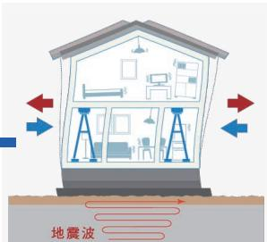
建物の強度を上げる地震対策ですが、建物が地震エネルギーを全て受け止めて耐えようとするため、構造躯体へのダメージが大きく、余震や別の地震の際に本来の性能を発揮できない可能性があります。
